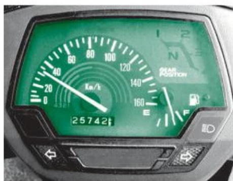
Hình 2.2 Tốc kế của xe máy.
