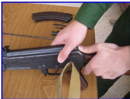
Hình 4-24. Tháo nắp hộp khoá nòng.
