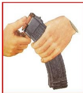
Hình 4-19. Lắp đạn vào hộp tiếp đạn.
