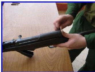
Hình 4-49. Tháo nắp hộp khoá nòng a, b) Tháo nắp hộp khoá nòng ; c) Tháo bộ phận đẩy về.
