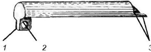
Hình 4-35. Nắp hộp khoá nòng 1. Mấu dưới; 2. Lỗ lắp then hãm; 3. Mấu lắp nắp hộp khoá nòng.
