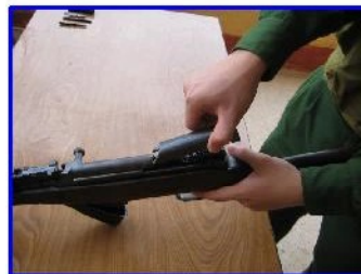
Hình 4-49. Tháo nắp hộp khoá nòng a, b) Tháo nắp hộp khoá nòng ; c) Tháo bộ phận đẩy về.
