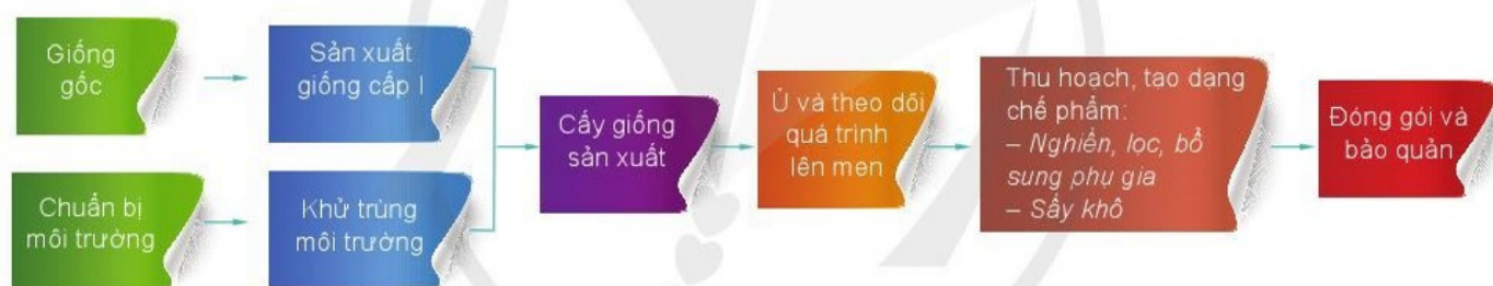
Hình 4.3. Quy trình sản xuất thuốc bảo vệ thực vật sinh học từ vi khuẩn Bt
