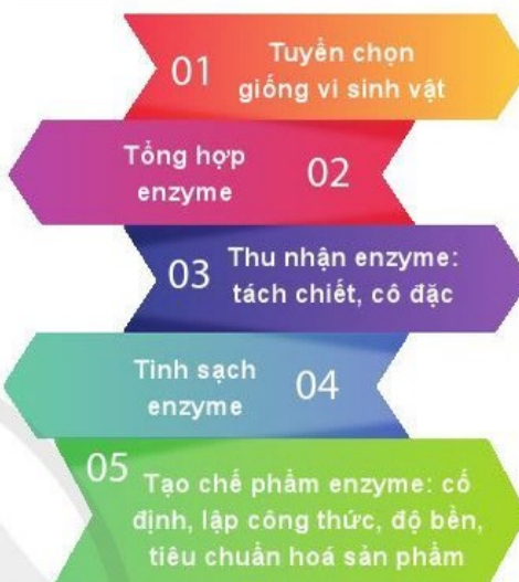
Hình 4.7. Quy trình công nghệ sản xuất enzyme từ vi sinh vật
