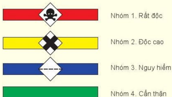
Hình 10.3. Vạch màu trên nhãn bao bì biểu thị độ độc của thuốc
